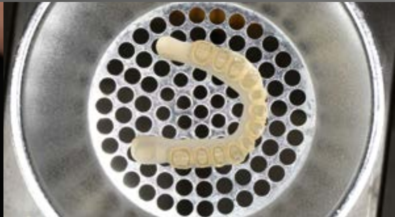
57 Zur Polymerisation des Primers kam die benetzte PEEK-Basis in ein Lichthärtegerät
